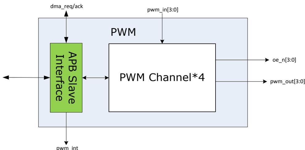
Fig. 18-1 PWM Block Diagram
