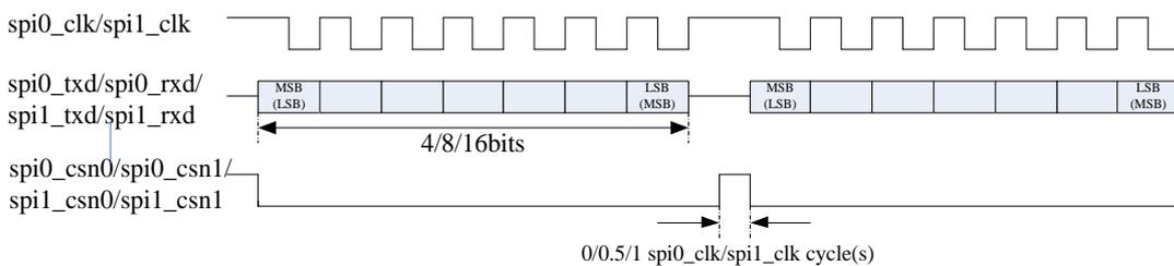
Fig. 23-4 SPI Format (SCPH=0 SCPOL=1)
