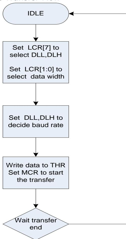
Fig. 19-8 UART none fifo mode
